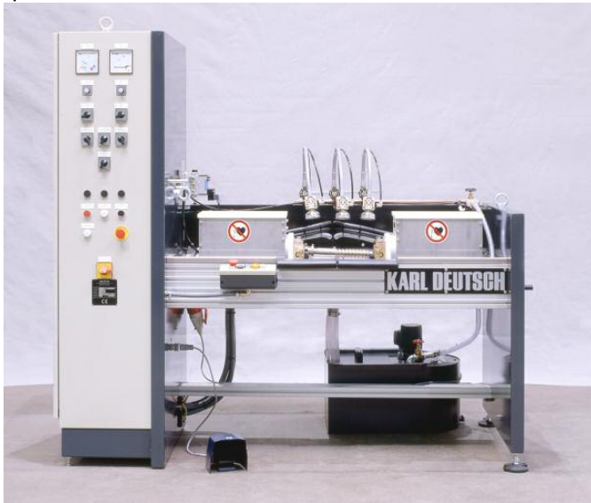
Bild 1. Gesamtansicht der Prüfanlage inklusive Schaltschrank, Fußschalter und Prüfmittelbehälter. Die Kurbel (rechts) dient zur zentrischen Verstellung der Joche. Rechtes Foto: Sitzarbeitsplatz
